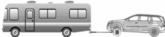
**BRAKES ARE REQUIRED ON TOWING DOLLY**
